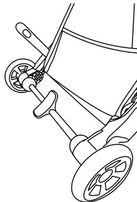
2. Como se muestra en la Figura 2, cuando el pedal del freno de la rueda trasera está pisado hacia abajo, las ruedas traseras están bloqueadas.
